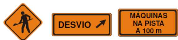
Fig. 4. Exemplo de sinalização de Obras.
