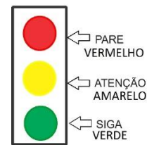
Fig. 3. Sinalização Semafórica de regulamentação
